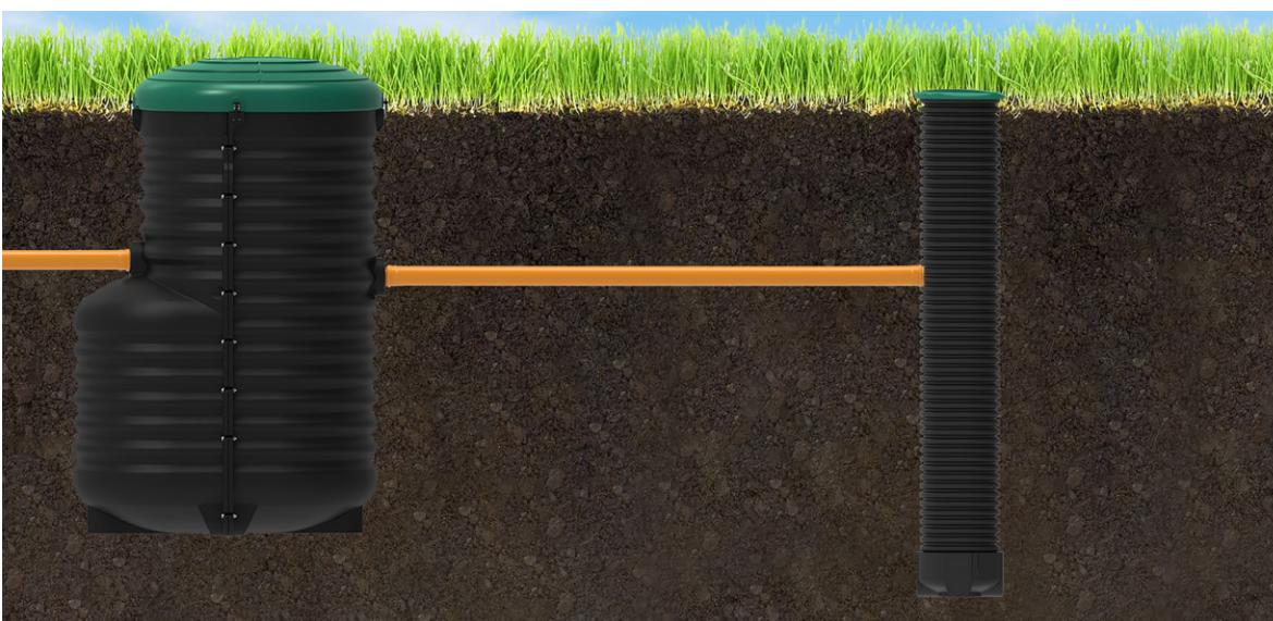
Вывод очищенной воды в накопитель с последующим сбросом в дренажную канаву и т.д.
